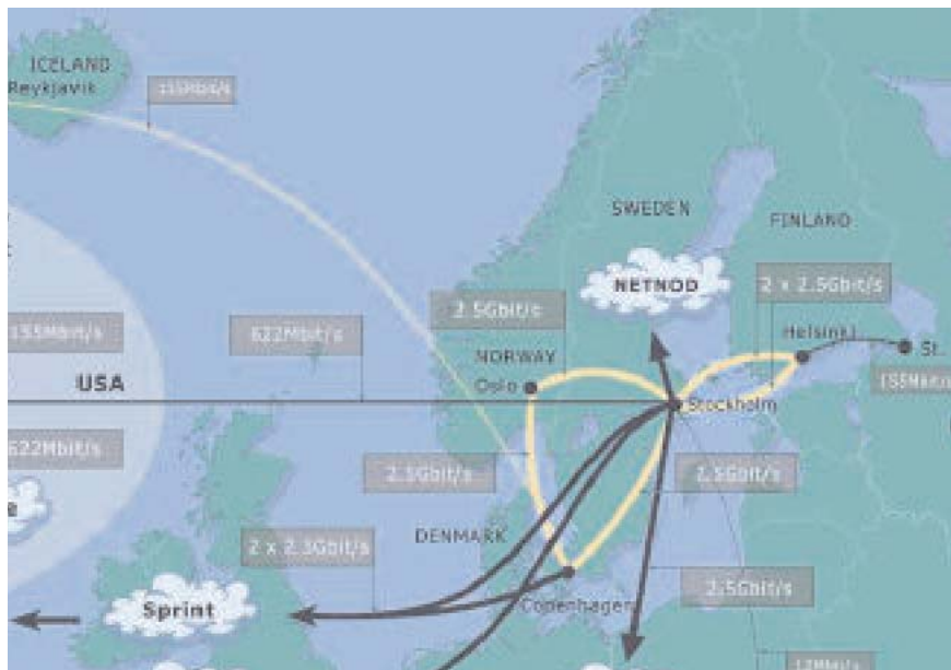
Рис. 4. Схема интернет-связности сети NORDUnet
